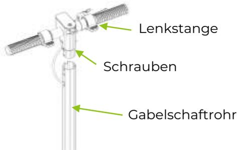
**VORSICHT:** Der mitgelieferte Schraubenschlüssel dient nur zur Vormontage. Die Schrauben müssen mittels eines Drehmomentschlüssels mit dem angegebenen Drehmoment angezogen werden.
