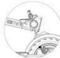
Stellen Sie sicher, dass Ihr STREETBOOSTER ausgeschaltet ist. Um ihn zu zusammenzuklappen, entriegeln Sie den Klappmechanismus (1) und biegen Sie den Lenkervorbau um. Diesen rasten Sie dann am hinteren Schutzblech (2) ein. Zum Öffnen ziehen Sie die Lasche (3) an der hinteren Einhängevorrichtung am Schutzblech. Nun können Sie den Lenker aufstellen und den Klappmechanismus verriegeln.
