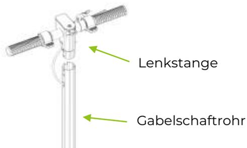
2. **Befestigen Sie die Lenkstange mittels der mitgelieferten Schrauben und nutzen Sie dafür einen Drehmomentschlüssel. Das Anzugsmoment für die Schrauben beträgt 5 NM.**
