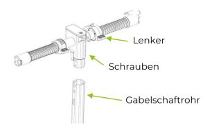
**VORSICHT:** Der mitgelieferte Schraubenschlüssel dient nur zur Vormontage. Die Schrauben müssen mittels eines Drehmomentschlüssels mit dem angegebenen Drehmoment angezogen werden.
