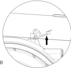
Stellen Sie sicher, dass Ihr STREETBOOSTER ausgeklappt ist. Um ihn zu zusammenzuklappen, entriegeln Sie den Klappmechanismus (1) und biegen Sie den Lenkervorbau um. Diesen rasten Sie dann am hinteren Schutzblech (2) ein. Zum Öffnen ziehen Sie die Lasche (3) an der hinteren Einhängevorrichtung am Schutzblech. Nun können Sie den Lenker aufstellen und den Klappmechanismus verriegeln.
