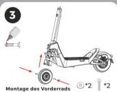
Setze das Vorderrad in die Gabel ein. Trage dann je einen Tropfen Schraubensicherung auf die beiden M8 Schrauben auf. Lege die Unter-legscheiben über die Schrauben und ziehe die Schrauben dann fest an.
